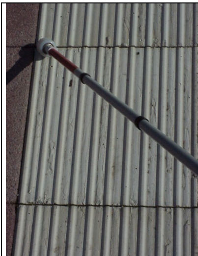
Abb. 13 a: Rippenstruktur 20/2,5 mm Leitfunktion: 2,94 Aufmerksamkeitsf.: 3,69 FüÙe: 5,83
