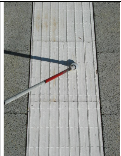
Abb. 11c: Hobis (Ebersbach) 40/3,5 mm Leitfunktion: 1,59 FüÙe: 3,63
