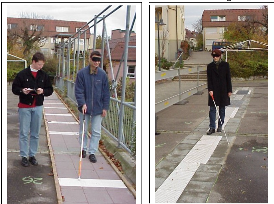
Abb. 2: Architekturstudenten beim Erleben der Teststrecke. Der Streifen mit längs verlaufenden, aneinandergereihten Bodenindikatoren dient dem Test der Leitfunktion, der Streifen mit kurzen quer verlaufenden Bodenindikatorenreihen dem Test der Aufmerksamkeitsfunktion.
