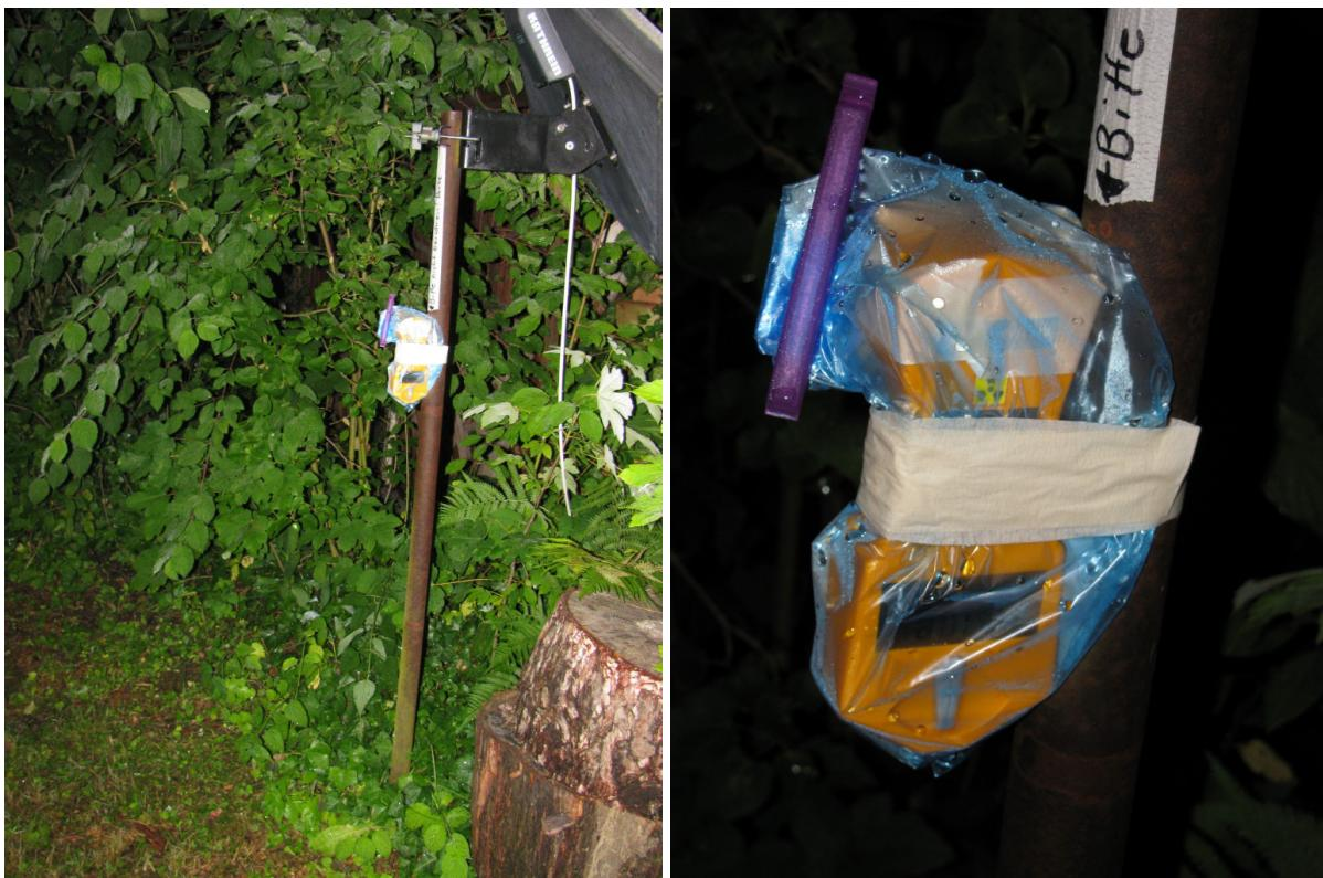
Für einen ersten Test wurde der Gammascout wasserdicht in einem Gefrierbeutel aufgestellt.
