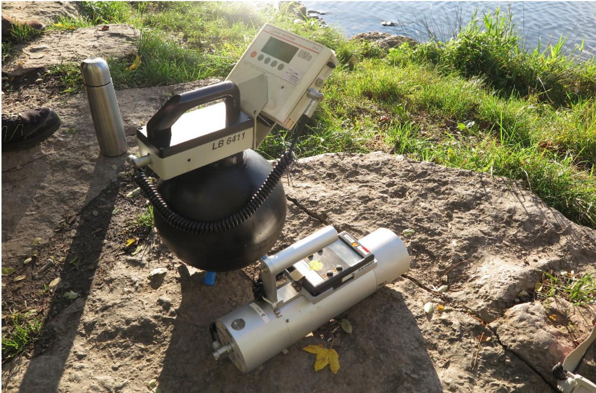
Das Equipment des LUBWs, Mittig der Neutronendetektor Berthold LB6411
