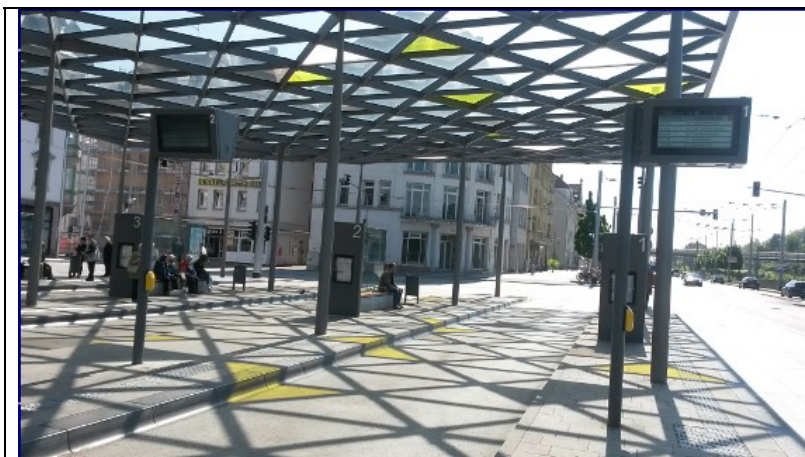
Abb. 6: Busbahnhof Esslingen Irritierende Schattenbildung des Glasdaches; kontrastloses Leitsystem (rechts am Bildrand)
