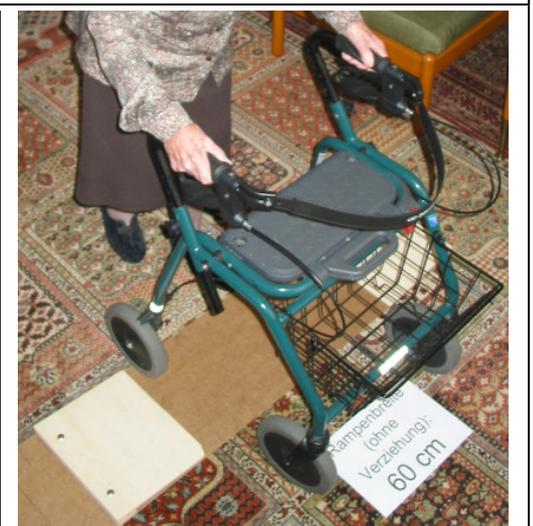
Abb. 28 - 30: Versuche mit einer Testrampe mit variabler Breite zeigten, dass auch Rampen mit weniger als 90 cm Breite bewältigt würden.
