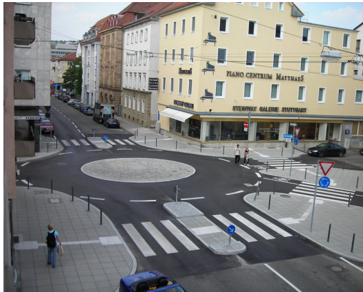
Bild 13a: Beispiel für eine Kreisverkehrsanlage mit Gemeinsamen Überquerungsstellen mit 3 cm Bordhöhe und Blindenleitsystem – erbaut vor Inkrafttreten der DIN 32984:2011-10 (Foto: Tiefbauamt Stuttgart)
