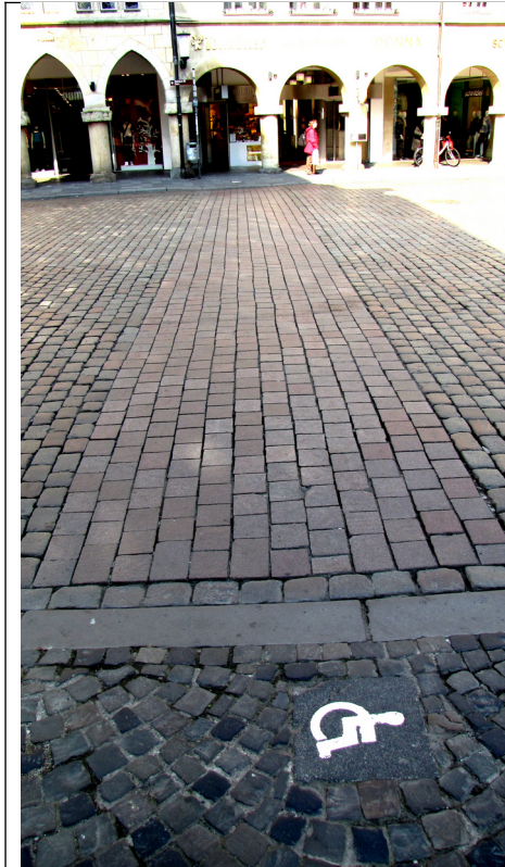
Bild 5: Münster / Westfalen, Prinzipalmarkt: Rollstuhlpiktogramme verweisen auf die erschütterungsarme Querungsmöglichkeit der sonst mit „Hoppelpflaster“ belegten Straße. Das noch sichtbare Piktogramm auf der gegenüberliegenden Straßenseite zeigt, dass es zumindest von Eingeweihten auf große Entfernung erkennbar ist, während es von nicht Betroffenen kaum wahrgenommen wird und daher selbst für den besonders sensiblen historischen Bereich keine Beeinträchtigung für das Stadtbild darstellt.
