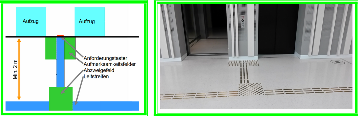
Abb. 13 a) Neu: Zwischen einer Aufzugstür und einem davor vorbeigehenden Leitstreifen muss ein Abstand von mindestens 2 m eingehalten werden [DIN 32984:2020-12, Bild 36 a)] Abb. 13 b) Perfekt gestaltete Hinführung zu einem Doppelaufzug
