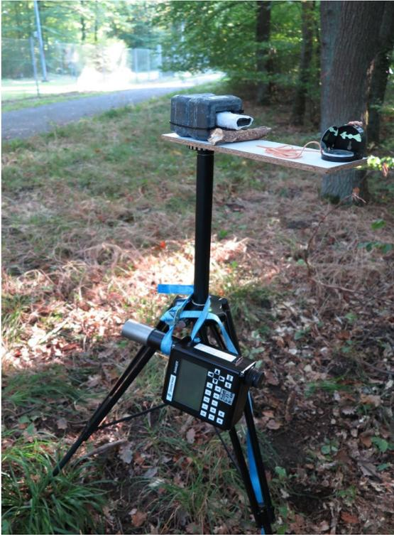
Messaufbau: oben der drehbare Kollimator mit dem, über Bluetooth bedienbaren "radiacode-101", unten der "Quantrad Sensor, Ranger" zur Neutronenmessung
